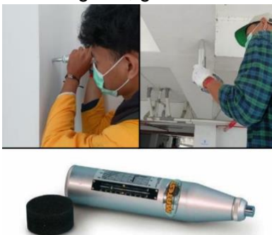
Gambar 1 Pengujian hammer test (SNI 03-4430-1997)
