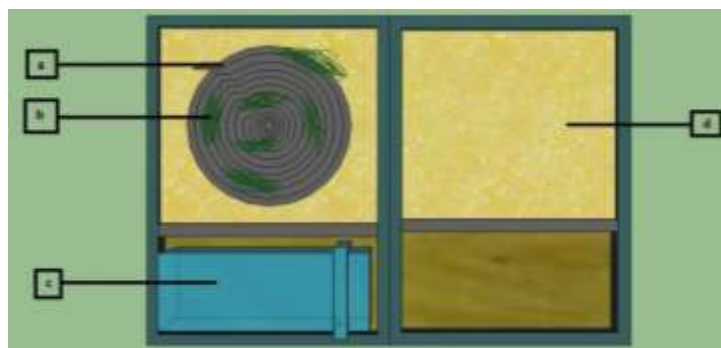
Gambar 2. Desain rumpon portable dari bahan fibre (Yusfiandayani et al. , 2013). Keterangan : a. Tali Atraktor; b. Atraktor Tali Rafia, c. Electric Fish Atractor , d. Pelampung (fibre).
