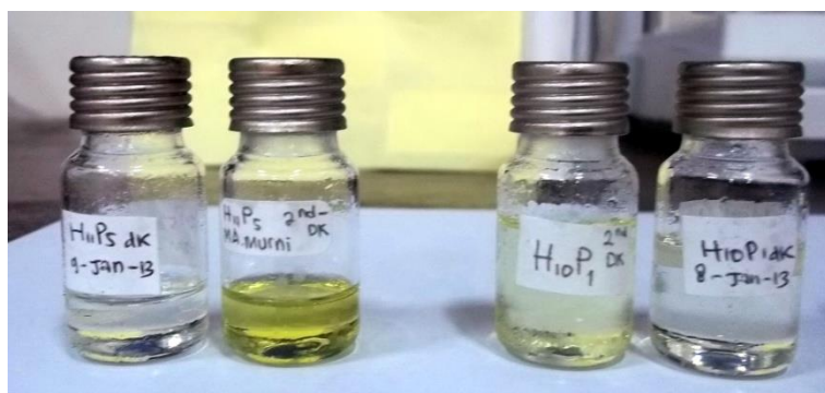
Gambar 1. Contoh hasil destilasi minyak atsiri L. cubeba
